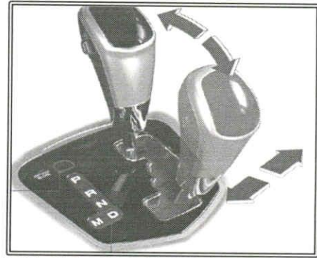
<fig41.기어 판넬부 구조(左) 및 기어 운동 방향(右)>
