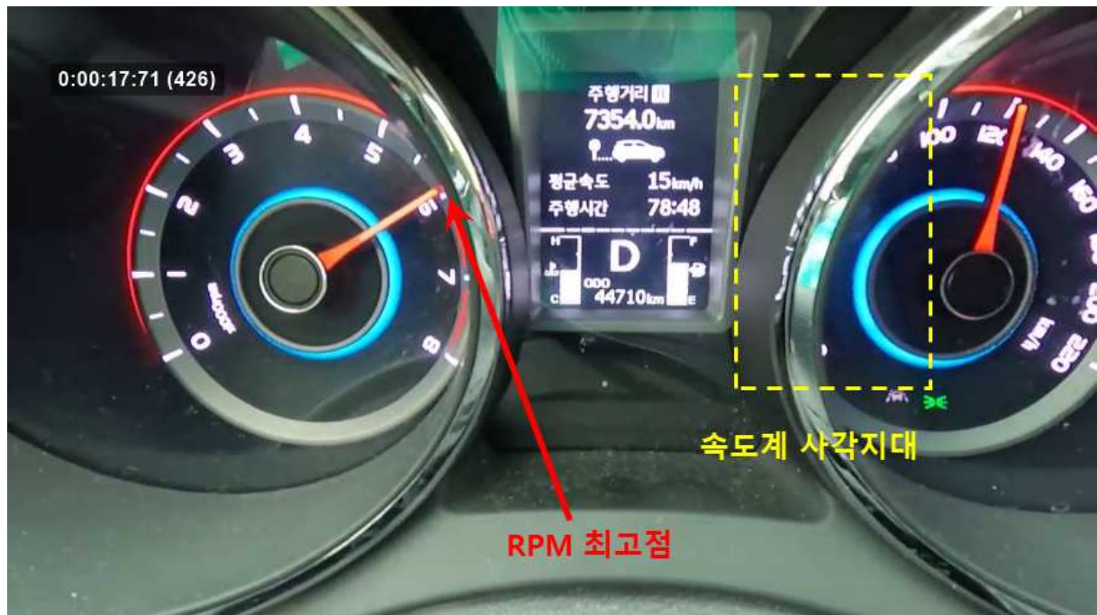
<그림 3. 출발시점에서 약 17.7초 후에 계기판의 RPM이 약 5900, 속도는 120km/h 정도로 추정됨>
