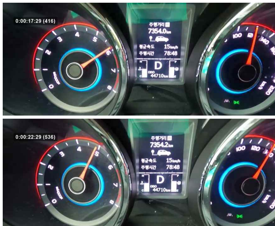
<그림 16. 120km/h 상태에서 5초 뒤 영상 138km/h 정도임>
