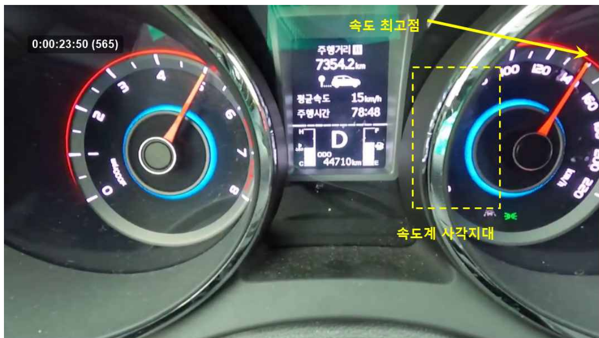
그림 4. 출발시점에서 약 23.5초 후에 계기판의 RPM이 약 5000, 속도는 140km/h 정도로 추정됨>
