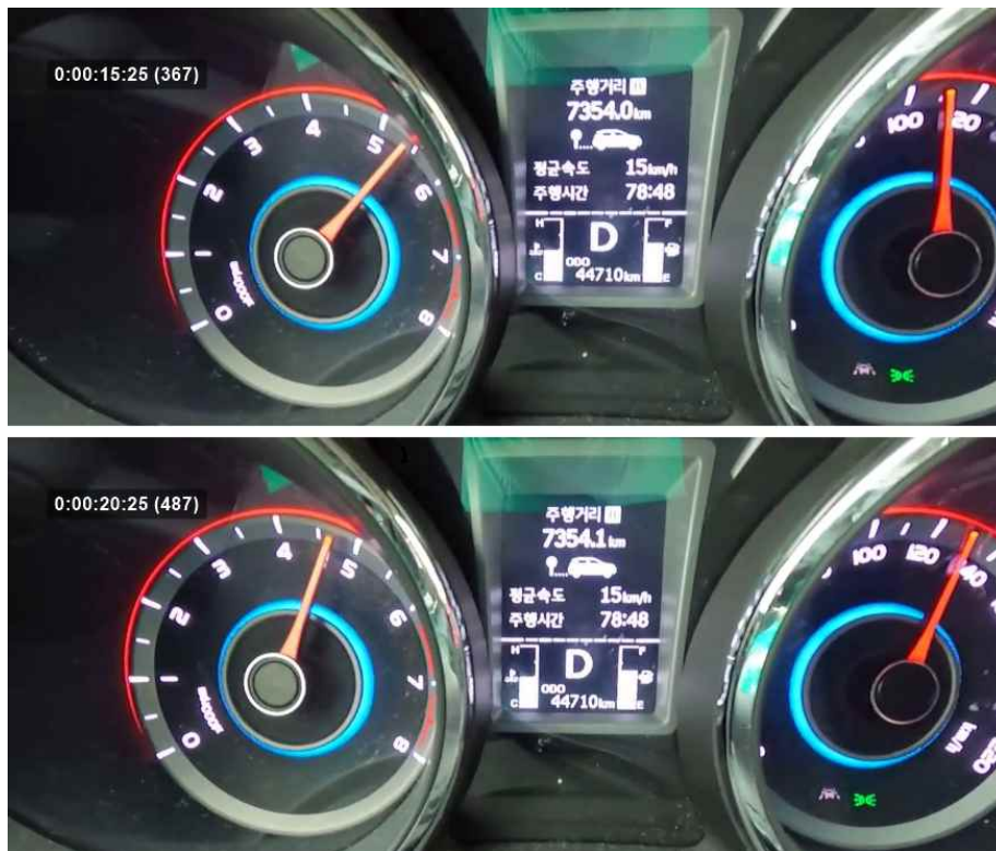
<그림 15. 110km/h 상태에서 5초 뒤 영상 130km/h 정도임>
