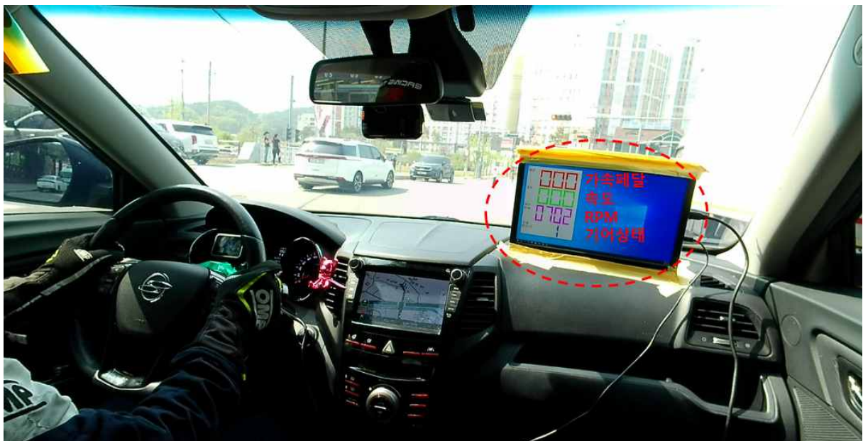
<그림 1. TCU, ECU 실시간 주행 정보 → 컴퓨터 → 모니터 표출 모습>
