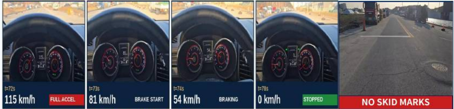
TEST 2 120km/h 급제동 정지까지 6초 소요
