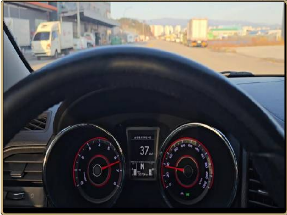
TEST 2 120km/h 급제동 정지까지 6초 소요
