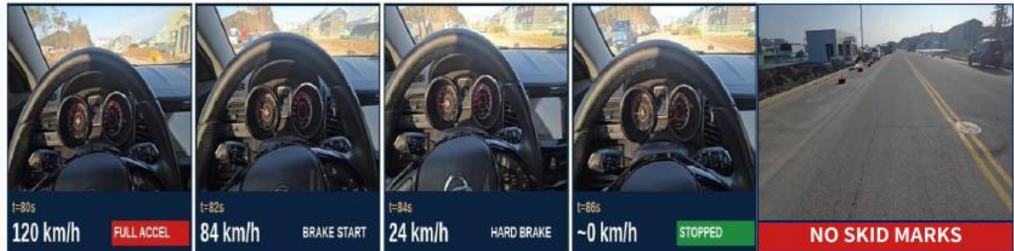
TEST 2 120km/h 급제동 정지까지 6초 소요
