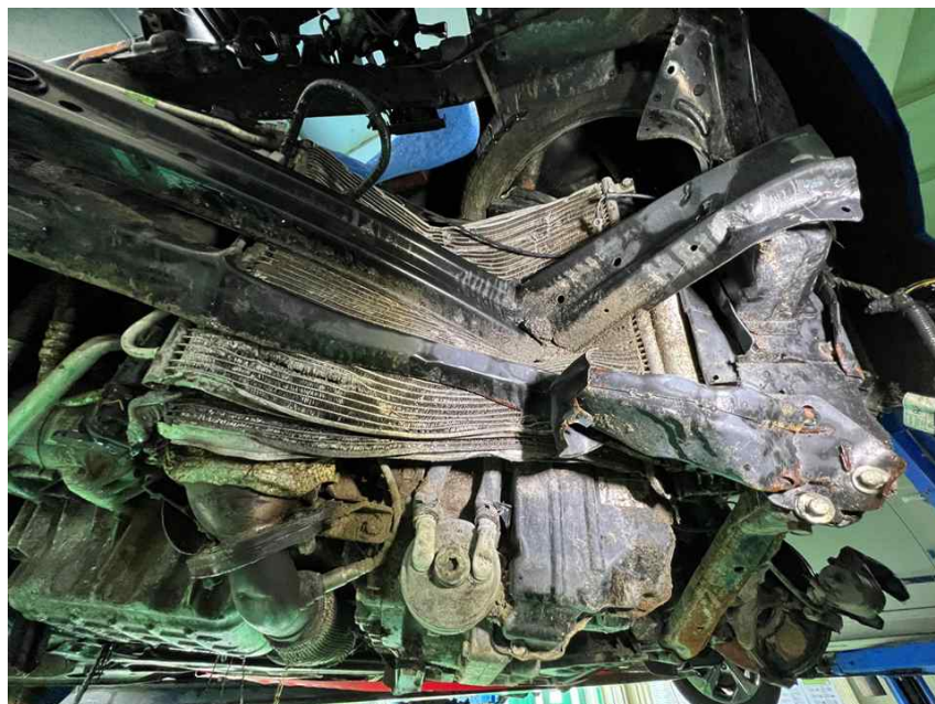
<차량 확인시점에서 라디에이터 파손 모습>
